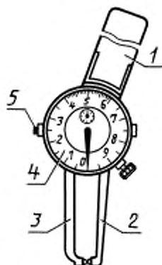
1 — ручка; 2 — неподвижный стержень; 3 — измерительный наконечник; 4 — отчетное устройство; 5 — арретир
