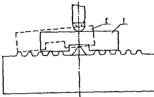
Превышение среднего ребра круглого ребристого стола над остальными ребрами и сферической вставки круглого стола над его рабочей поверхностью не должно превышать соответственно 0,4 - 0,6 мкм и 2 - 3 мкм.
